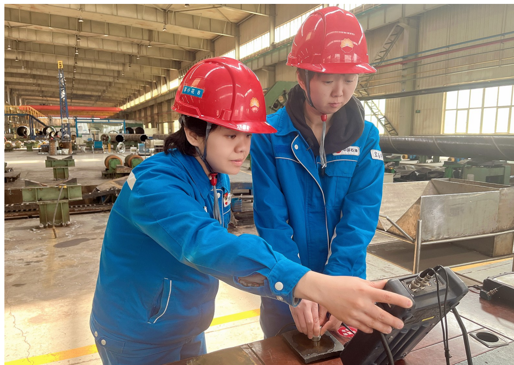
苏小花(左)指导岗位员工调试超声波手探仪。
