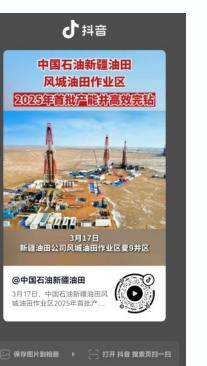
该作业区夏9井区首轮水平井批量钻井工作高效完钻。通过“打水平井+体积压裂”技术试验,可把零散分布的“小土豆”串联成整片大块的“金元宝”,让低产油藏重新焕发活力。
